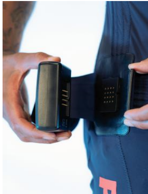
Immagine 6: Fissare il Battery Box alla tuta
