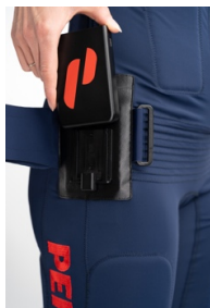
Rysunek 7: Wsuwanie zasilacza w prowadnice po prawej stronie kombinezonu
