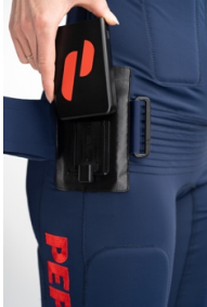
Kuva 7: Teholaitteen liu'uttaminen puvun oikealla puolella oleviin kiskoihin
